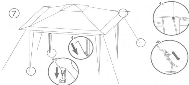
**Schritt 7:** Die Beinverkleidung des großen Stoffdaches am Gestell einhaken. Anschließend den Pavillon an den Füßen mit vier Erdspeießen (Teil F) fixieren. Für zusätzliche Stabilität werden die vier Spannseile (Teil E) am Stoffdach befestigt und anschließend unter Spannung am Boden mit den Erdspeießen fixiert. Mit Hilfe der Längenregulierung an den Seilen kann die Spannung nachjustiert werden.
