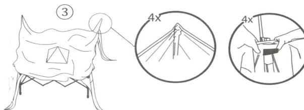
**Schritt 3:** Legen Sie das große Stoffdach (Teil B) auf das Gestell. Achten Sie darauf, dass die äußeren Ecken von Gestell und Stoffdach genau aufeinander treffen. Ziehen Sie das Dach an allen vier Ecken über die überstehenden Streben. Danach alle Klettverschlüsse an den Ecken schließen.
