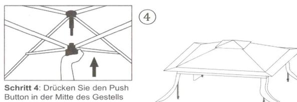
**Schritt 4:** Drücken Sie den Push Button in der Mitte des Gestells nach oben bis dieser fest in der Vorrichtung einrastet. Das Stoffdach spannt sich dadurch komplett auf.
