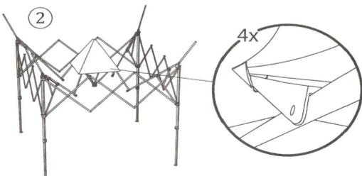
**Schritt 2:** Platzieren Sie das kleine Stoffdach (Teil C) mittig auf dem Gestell und ziehen alle vier Ecken des Stoffdaches vorsichtig über die flexiblen Kunststoffecken am Gestell.
