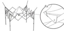
7. Das Gestell kann nun inkl. Stoffdach vollständig zusammengeklappt werden.
