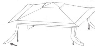
4. Lösen Sie an zwei nebeneinanderliegenden Seiten die Hebel an den Pavillonbeinen. Stellen Sie die Beine auf die niedrigste Höhe und fixieren die Hebel. An den anderen beiden Beinen wiederholen.
