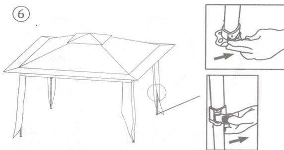
**Schritt 6:** Stellen Sie die Beine auf die gewünschte Höhe ein. Heben Sie dazu zwei nebeneinanderliegende Beine gleichzeitig leicht an und lösen den Hebel an der Höhenverstellung. Ziehen Sie das Bein auseinander, bis die gewünschte Höhe erreicht ist. Stellen Sie sicher, dass die Höhenverstellung komplett einrastet. Den Hebel nun wieder feststellen.
